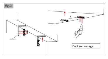
Appendere ora la tenda ai supporti in modo che il cassonetto sia premuto al massimo contro le staffe. Fissare la tenda da sole con le viti di bloccaggio. Si trovano sul lato inferiore del telaio di supporto.
