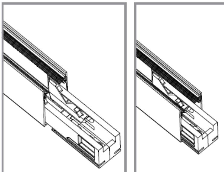
Inserire i piedini nella parte inferiore delle guide.
