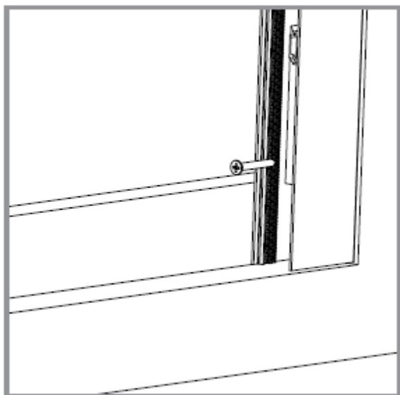
Fissare i piedini alle pareti laterali utilizzando i fori di cui al 1).
