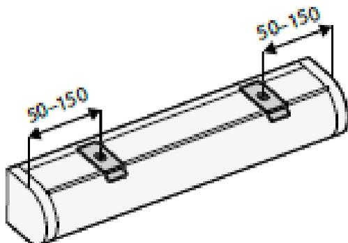
Inserire la cassetta in alto nelle staffe (opzionali) e fissarla in basso con una vite di fissaggio.
