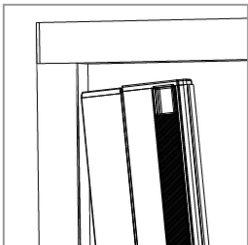
Inserire la barra maniglia sotto la guida superiore facendolo aderire all'interno del telaio.
