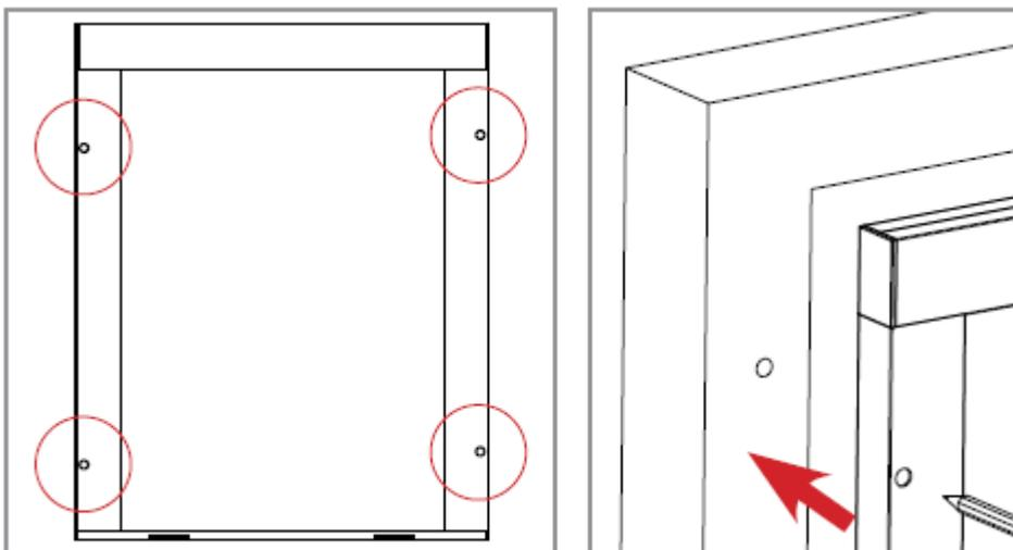
Posizionare il telaio e predisporre il fissaggio.
