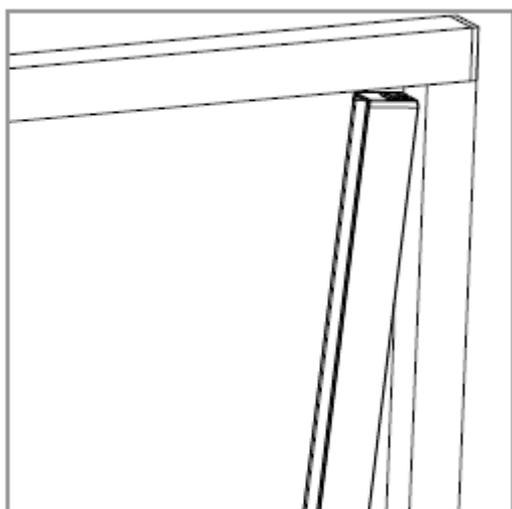
Inserire il profilo di riscontro sotto la guida superiore e farlo aderire al telaio, scivolando delicatamente lungo la guida inferiore.
