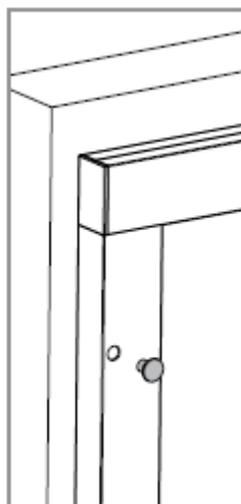
Fissare il telaio al vano utilizzando gli appositi fori sulle guide laterali. Coprire i fori con i tappini in dotazione.
