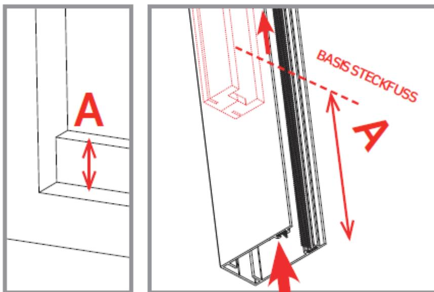
Die Höhe (A) der Erhebung auf der Basis der Öffnung abmessen. Die Steckfüße in die Führungen nach oben schieben, bis die Basis des Steckfußes die Höhe „A“ der Erhebung erreicht.
