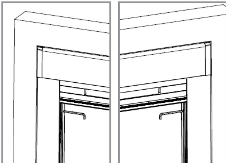
Die abschließenden Teile an den seitlichen Wänden befestigen, indem man die vorhandenen Madenschrauben mit einem Schlüssel anschraubt.
