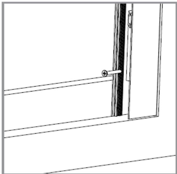
Die Steckfüße an den seitlichen Wänden befestigen und dabei die bei Punkt 1) genannten Löcher verwenden.
