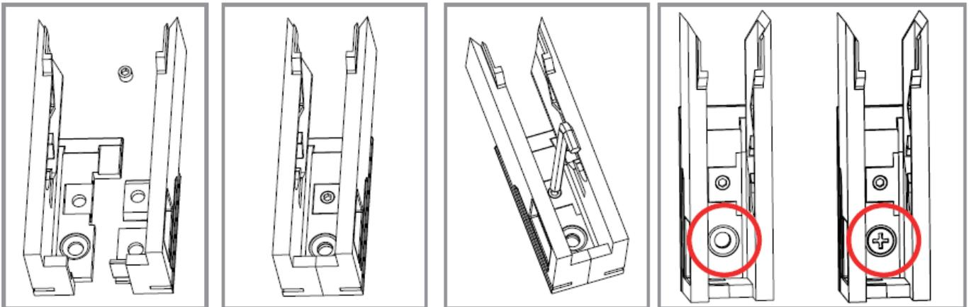
Die Steckfüße montieren und sie mit den gelieferten Madenschrauben verbinden. **ACHTUNG:** Die mit dem Kreis gekennzeichneten Löcher werden nach dem Einsetzen in die Führungen für das Einfügen der Spannschrauben der Steckfüße verwendet werden.
