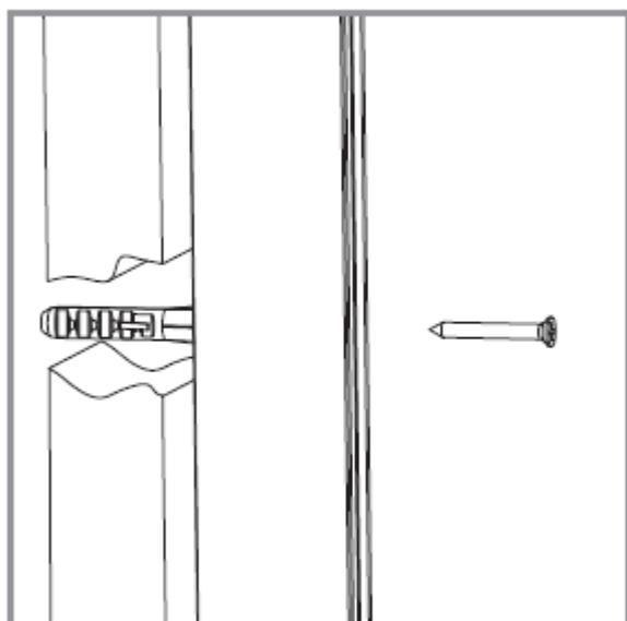
Die Führungen an den seitlichen Wänden befestigen und dabei die bereits vorhandenen Löcher verwenden.
