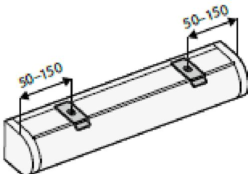
Kassette oben in die Winkel (optional) einsetzen und unten mit einer Madenschraube befestigen.
