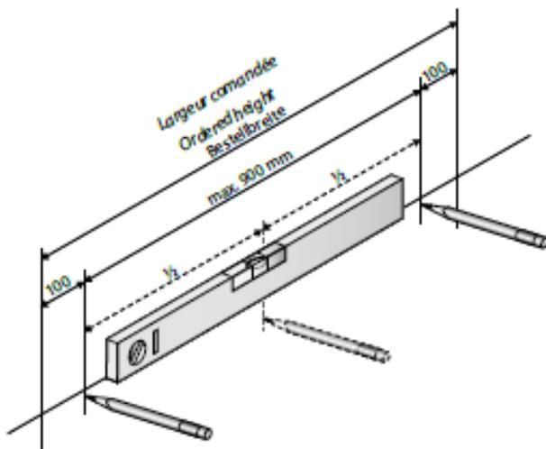
Bei der Montage der Clips bitte beachten, dass der Abstand zwischen Halter und Rollo-Ende 50-150 mm beträgt.
