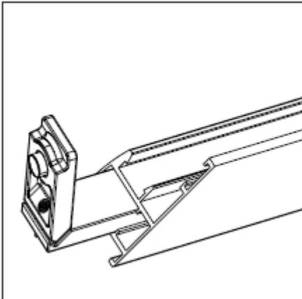
Setzen Sie die Halterung in den oberen Rahmen ein. Drücken Sie die Halterung in das Profil, bis Sie ein Klicken hören.
