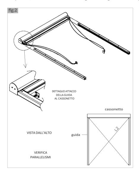
Befestigen Sie die Führungen an der vorhandenen Struktur (Abb. 3). HINWEIS: Die Art der Verankerung hängt von den Eigenschaften der vorhandenen Markisen-Tragkonstruktion ab.
