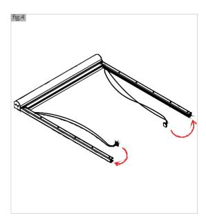
Setzen Sie die Klemmenschlitten auf beiden Seiten in die Führungen und wickeln Sie die Kabel ab, ohne sie zu verdrehen (Abb. 5).
