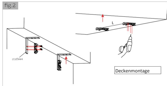
Hängen Sie jetzt die Markise in die Halter, sodass die Kassette maximal an die Konsolen gedrückt wird. Sichern Sie die Markise mit Hilfe der Sicherungsschrauben. Diese befinden sich an der unteren Seite des Trägerrahmens.
