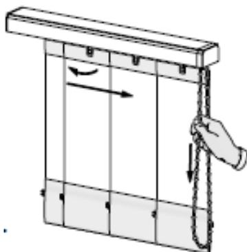
Durch Zug an der Bedienkette in die Gegenrichtung wende die Lamellen. Der Behang öffnet sich.
