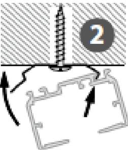
Nut der Führungsschiene in die vordere Zunge der Halteclips einhängen und anschließend einrasten
