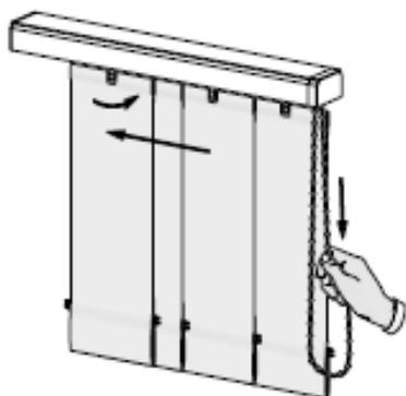
Durch den Zug an der Bedienkette wenden die Lamellen komplett und fahren anschließend zu.
