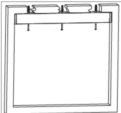
Befestigen Sie die obere Schiene durch Bohren von Löchern an der Tür.
