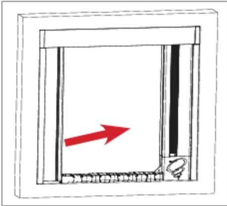
Schieben Sie das Insektenschutzgitter unter die obere Schiene auf der Seite, und bringen Sie es in Richtung der Seitenwand.
