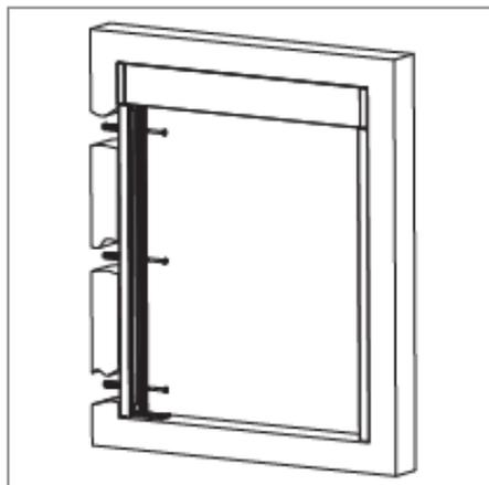
Sichern Sie das Seitenprofil durch Bohren Löcher.
