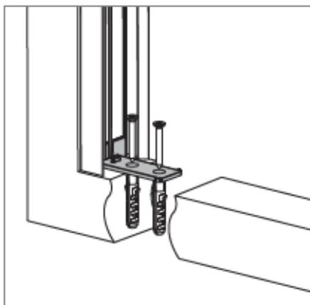
Befestigen Sie die Kupplung am Türrahmen
