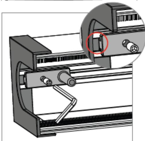
Das Seitenteil an der Kappe positionieren (die Kerbe - in rot - dient als Schablone) und erst dann mit der Madenschraube befestigen.
