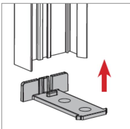
Setzen Sie den unteren Haken in das Profil ein ohne Magnet.
