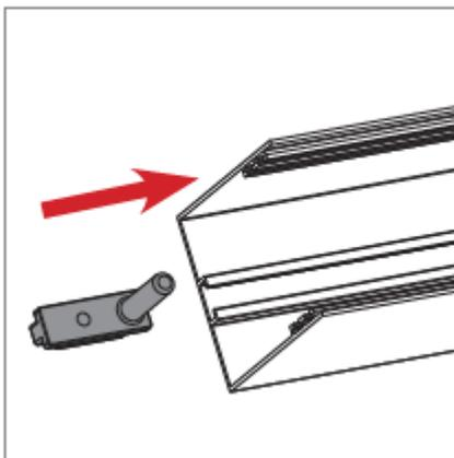
Führen Sie das Seitenteil in die Nut der oberen Schiene ein. (Hinweis: Durch das Einsetzen des Seitenteils wird das Profil unbeweglich, so dass das Insektenschutzgitter von der gegenüberliegenden Seite geöffnet werden kann).
