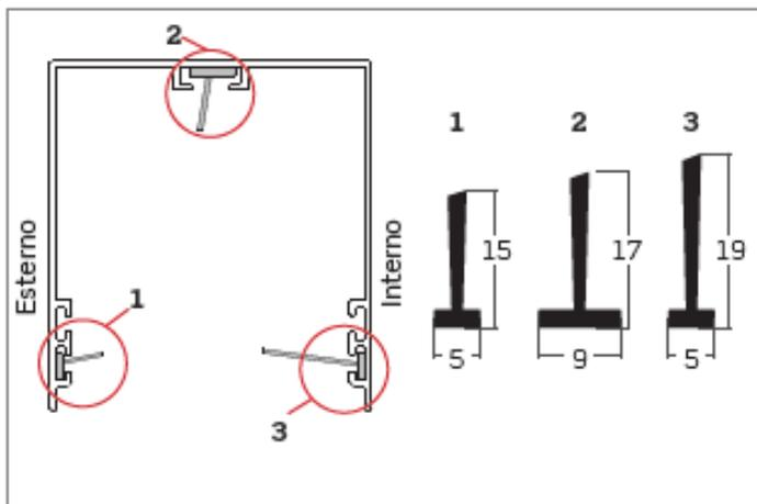
Setzen Sie die Bürsten in die obere Führung ein.
