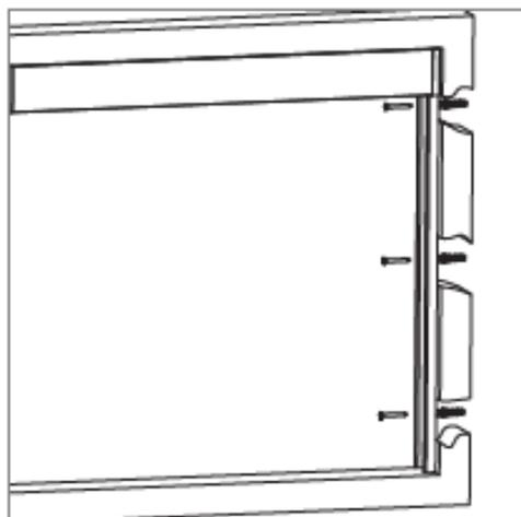
Positionieren Sie das Seitenprofil und befestigen Sie es durch Bohren von Löchern.
