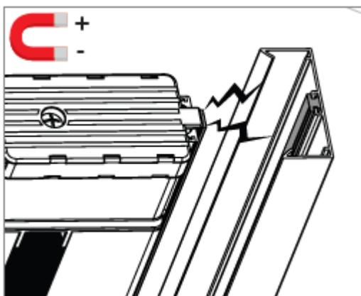
Überprüfen Sie die Polarität des Magneten.
