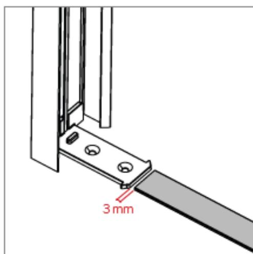
Entfernen Sie die Schutzfolie des doppelseitigen Klebers von der unteren Schiene, bringen Sie die Schiene auf dem Boden zwischen den beiden Seitenprofilen an. Bringen Sie die Schiene am Falz an und lassen Sie dabei einen Abstand von 3 mm zur unteren Schiene.
