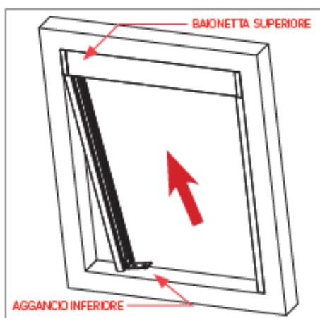
Setzen Sie das Seitenprofil nach innen ein der oberen Führung und kleben sie an der Seitenwand.
