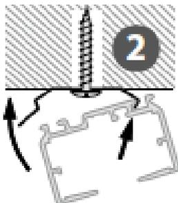
Agganciare la scanalatura del binario di guida alla linguetta anteriore delle clip di fissaggio e farla scattare in posizione.
