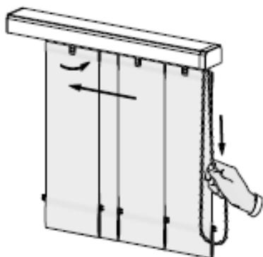
Tirando la catena di comando, le lamelle ruotano completamente e si chiudono.
